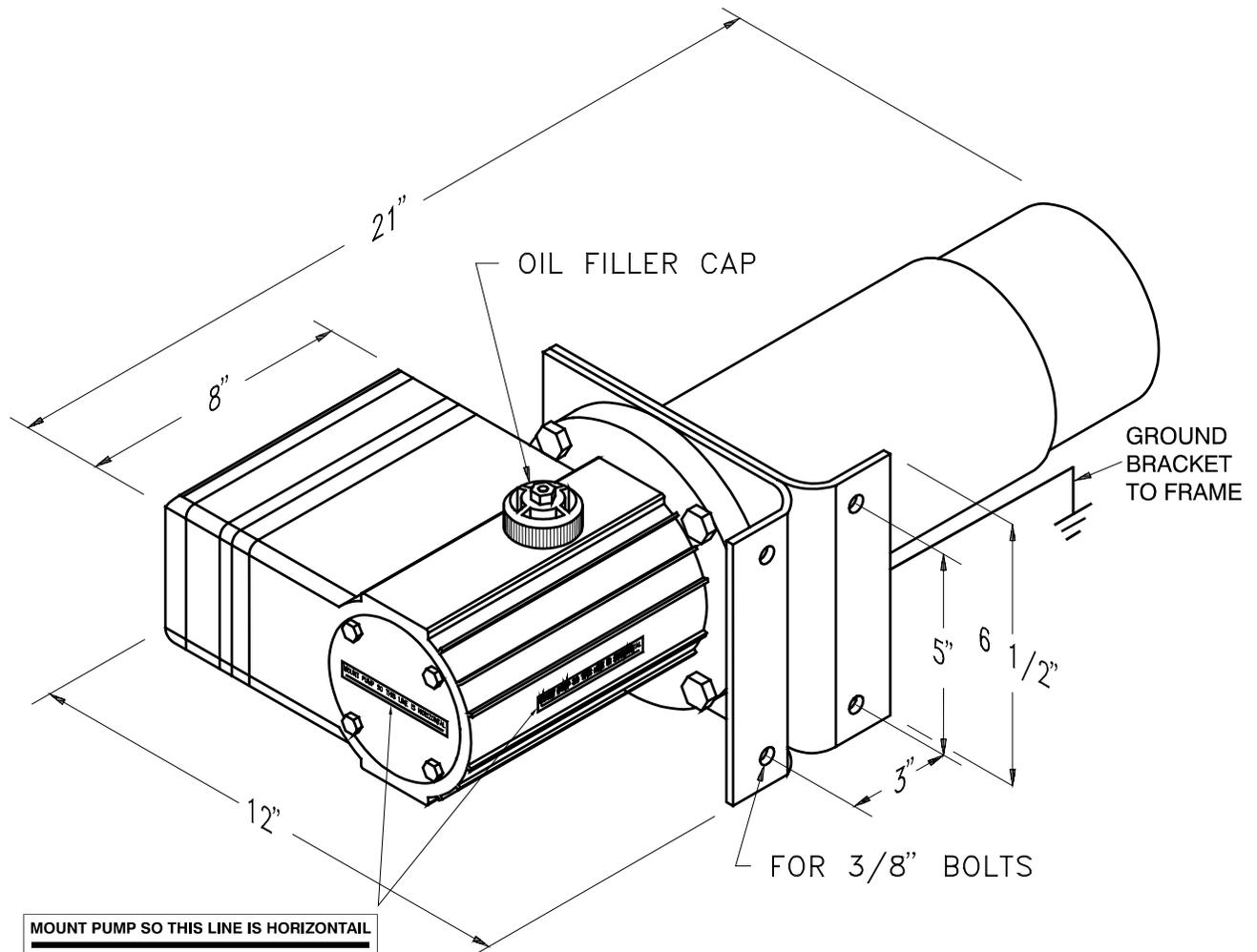
**FIGURE 6 PUMP/MOTOR HOUSING**
