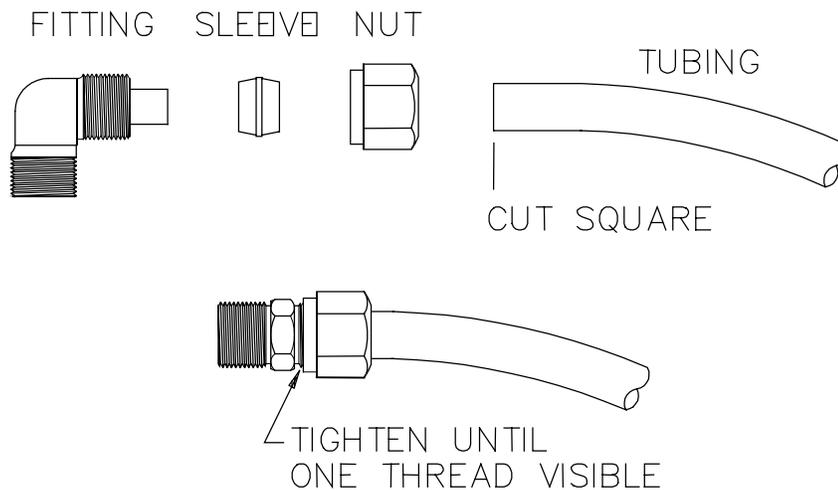
**FIGURE 5 COMPRESSION FITTING USE**
