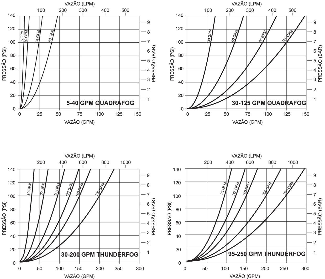
**FIGURA 2 - CARACTERÍSTICAS DE VAZÃO DOS ESGUICHOS**
