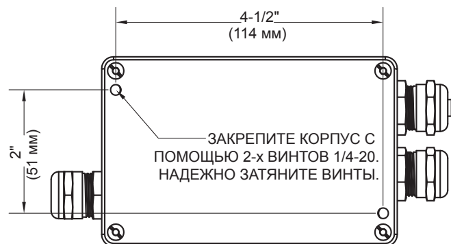
Рис. 2.9.1 Размеры крепежных отверстий для дистанционного вспомогательного интерфейса
