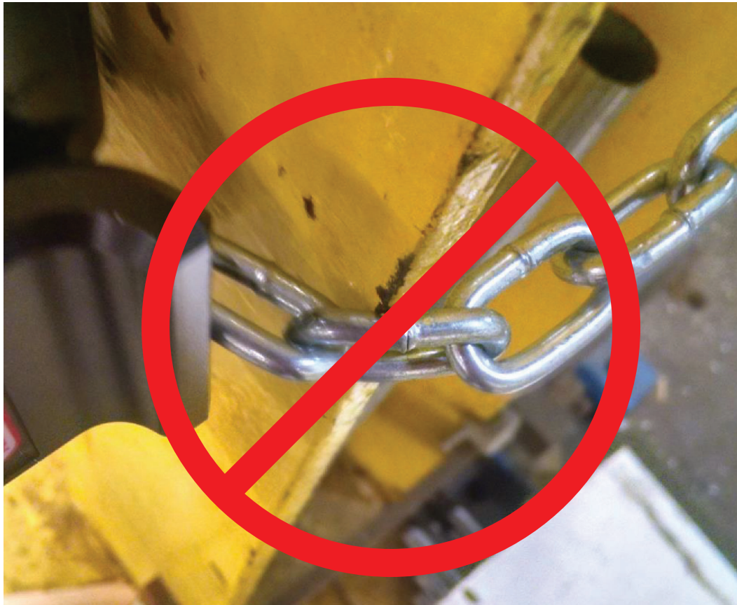
Figura 2.17 Debe evitar doblar la cadena en esquinas.
