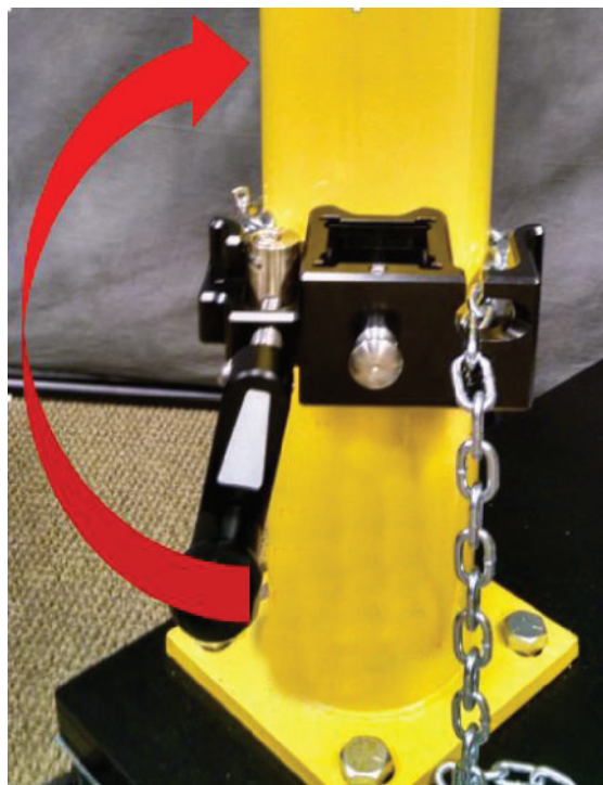
Figura 2.26 Tensando la cadena
