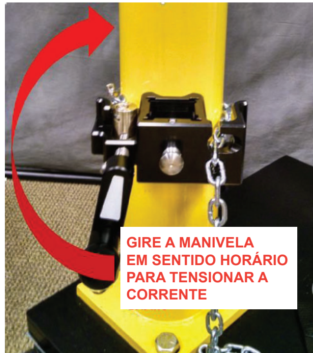
Figura 2.26 tensionando a corrente
