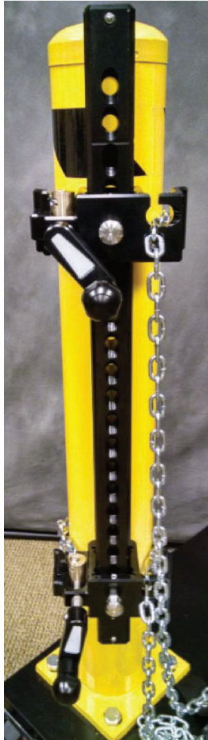
La Figure 2.29 Installation de l'autre palan à chaîne
