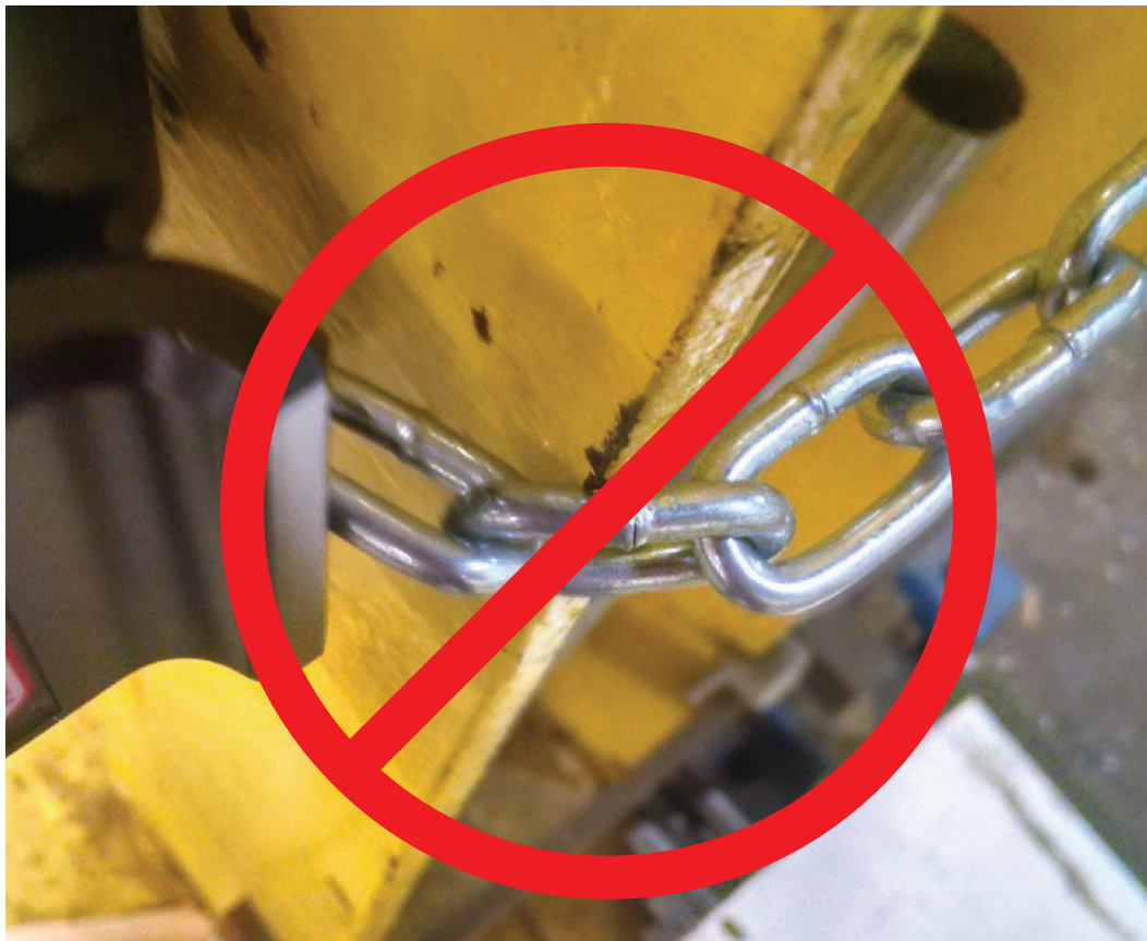
La Figure 2.17 Éviter de courber la chaîne sur les coins
