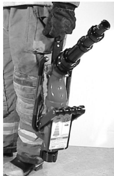
Figura 5.2 Llevando el Blitzfire en una manguera descargada
