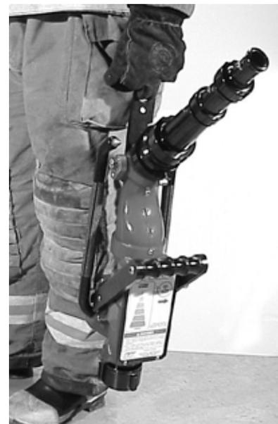
Abb. 5.2 Tragen eines Blitzfire an einem ungeladenen Schlauch
