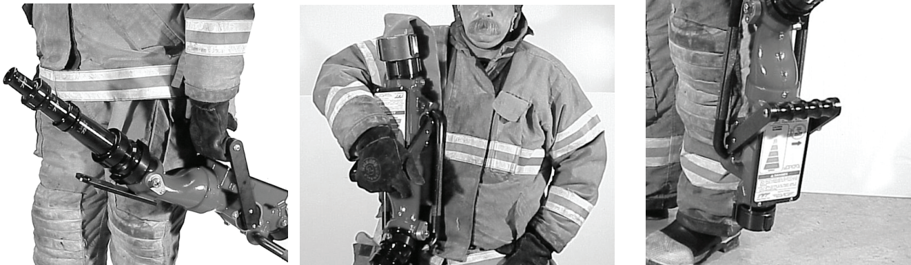
Figure 5.2 Porter le Blitzfire sur un tuyau non chargé
