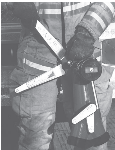
Rysunek 4.2.2 Jeden zestaw nóżek jest rozłożony i zablokowany w pozycji roboczej
