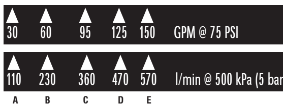
Figura 4.2B 1.5" / 38 mm G-Force 75 psi / 5 bar Ugelli fissi e selezionabili
